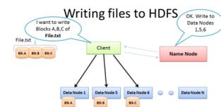
Le client divise **File.txt** en 3 blocs. Pour chaque bloc, le client consulte le **Name Node** et reçoit 3 **Data Node** qui reçoivent les 3 blocs.
